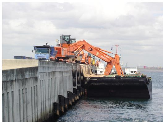
船に積まれた廃棄物を大型油圧ショベル2台でダンブに積み替える
