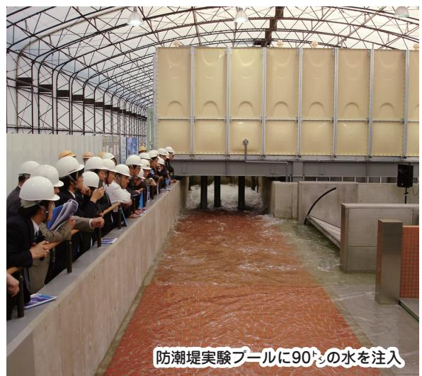
防潮堤が水圧で立ち上がり押し寄せてくる水を防ぎ止める。動力源として電力を使わないので、防潮堤の電源スイッチを入れに行く途中で災害に遭うこともなく、また通常時のメンテナンスも簡単とのことである。防潮堤の幅や高さも現場に応じて設計可能とのことであった。実験施設で90トンの水が押し寄せてきて防潮堤が立ち上がる様子は一見の価値があった。そして90トンの水がタンクに吸い上げられる早さに驚いた。見学位置を変えながら通常は2回のところを3回も見せて頂いた。大阪の地下街や地
