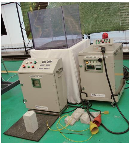
放電破碎工法設備
