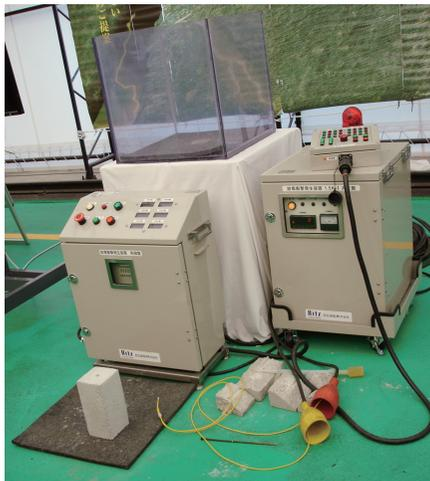
放電破砕工法設備
